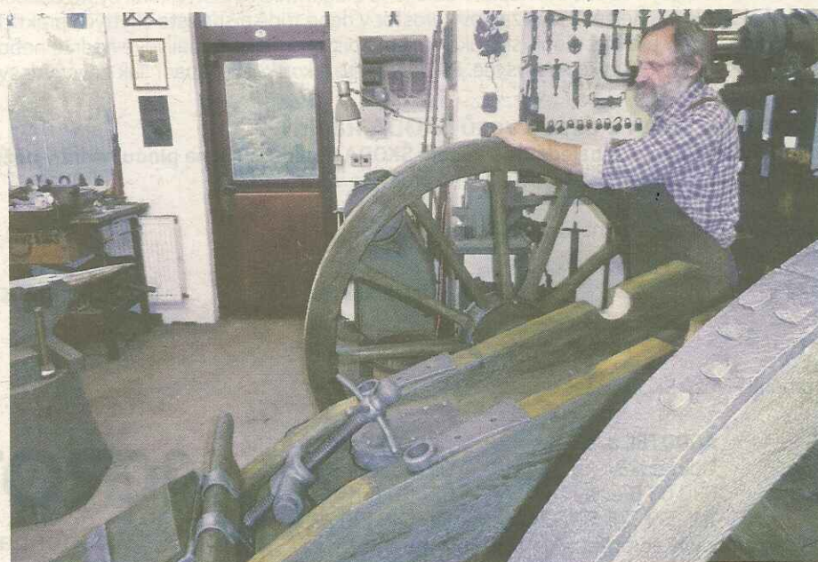
Kolo okované železnými pláty sotva unesou dva chlapi. Jsou na nich i hřeby, aby neproklouzávaly.
